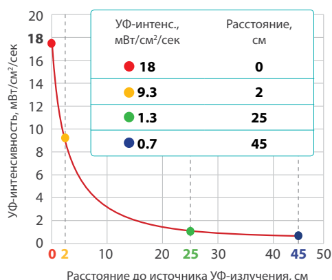
Рис. 1.1. Падение интенсивности УФ в зависимости от расстояния до поверхности источника УФ
